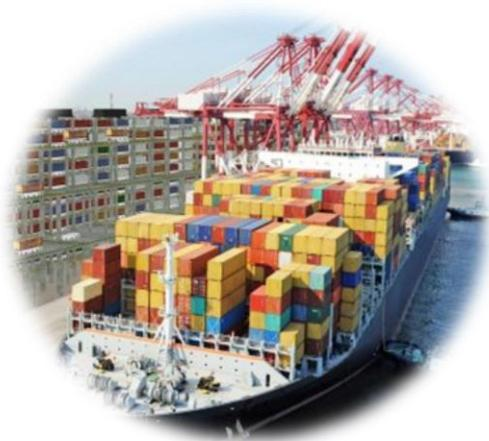
**Terminal de contenedores de aguas profundas DCT, en Gdańsk (Polonia):** el estudio de factibilidad de la segunda terminal de carga de DCT recomendó que la altura del muro del muelle tuviera en cuenta las proyecciones de aumento del nivel del mar.
