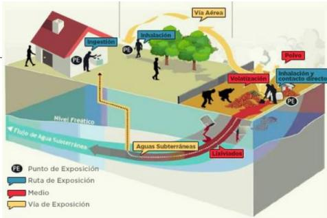
**Modelo conceptual:** vías de exposición - receptores - medios - puntos de emisión.
